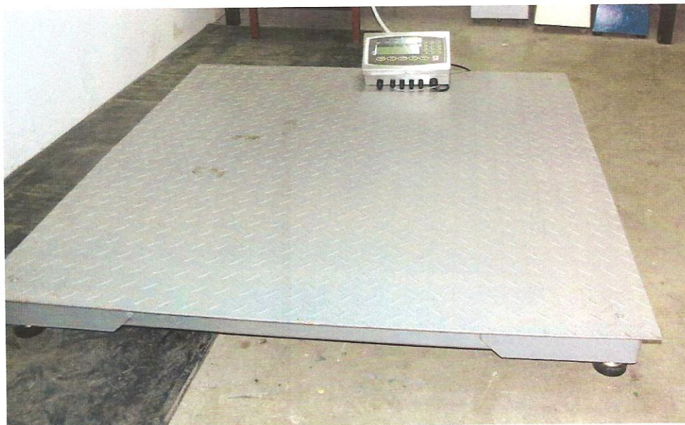
Izgled vage T71XW s pravokutnom platformom.
